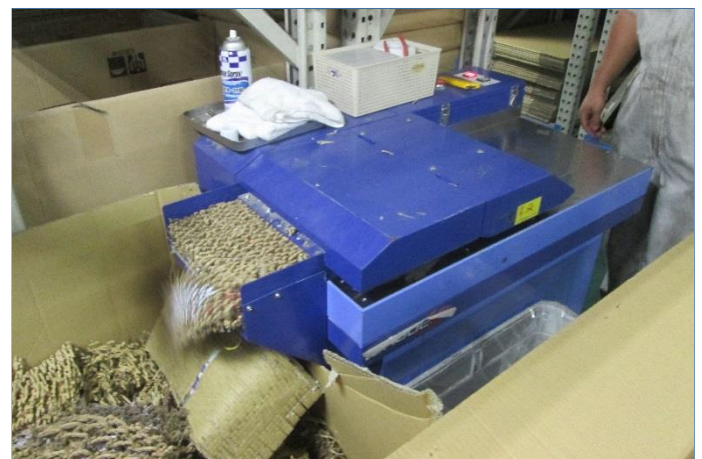
▲機械で細かくしたダンボールが部品梱包時のクッション材
